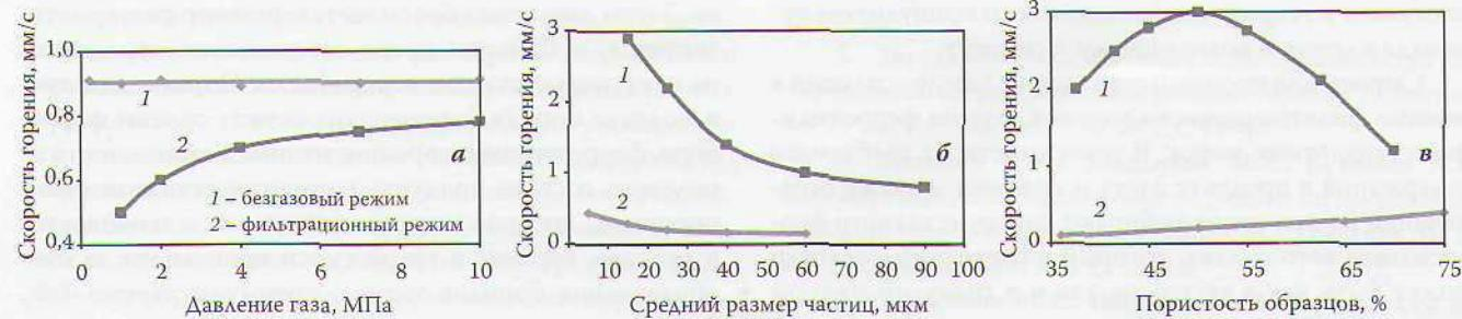
Рис. 2. Зависимость скорости горения от давления газа (а), дисперсности порошка ферросплава (б) и пористости шихты (в): 1 – (Fe–B)–Ti, 2 – (Fe–Si)–N<sub>2</sub>
