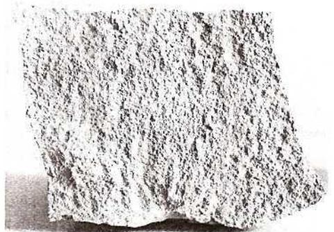
Рис. 3. Макроструктура СВС-нитрида ферросилиция
